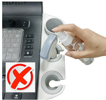
Obrázek 3-22. NEAPLIKUJTE sprej na sondu, když je umístěna v držáku
